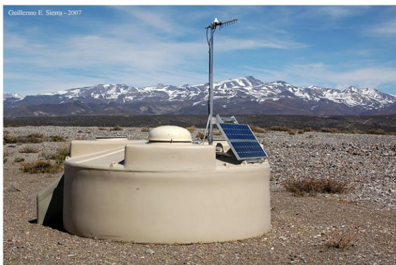
(a) Detector de luz Chérenkov en agua
